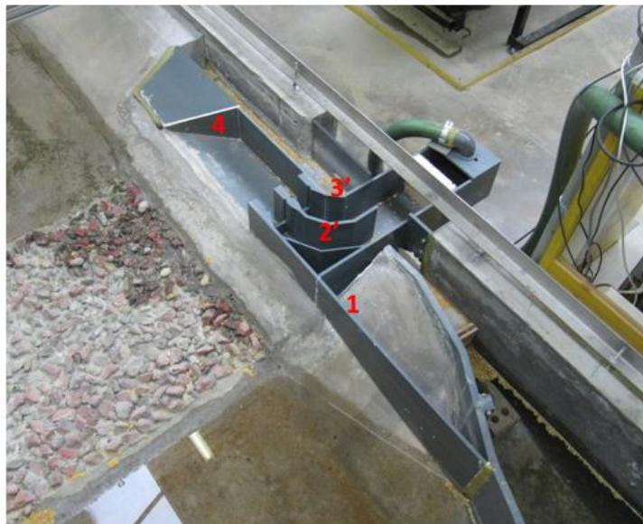
Figure 51: Entrées aval rive droite – Variante 2 : entrée inclinée à 90°. Etat final avec le mur amont pour empêcher le décollement du flux (1), le mur guideau allongé et affiné pour optimiser la répartition du débit sur les deux vannes (2), la 2<sup>ème</sup> modification de l'intérieur de la courbe en un pan (3) et la simplification de la transition « en sifflet » avec la rive à l'aval.
