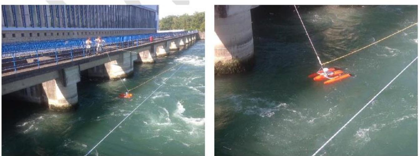
Figure 18 – Mesures de profils de vitesse en sortie des aspirateurs des turbines par mesure à l'ADCP
